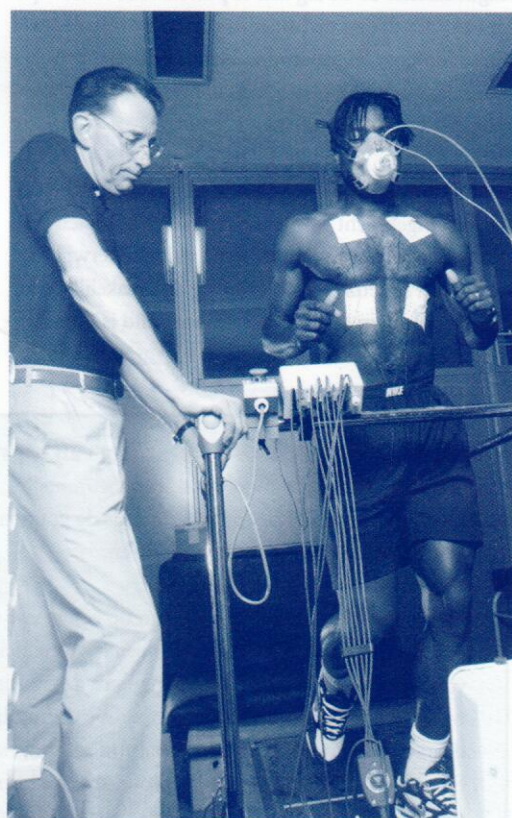
De gouden standaard voor de bepaling van de aërobe capaciteit, de belangrijkste energieleverancier voor een wedstrijd (70% aërobe prestatie) blijft een loopbandtest in het sportlabo (Photonews).
