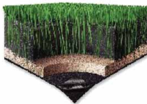
Fig. 2: doorsnede van de verschillende lagen van een kunstgrasveld ©www.tarkettports.com
